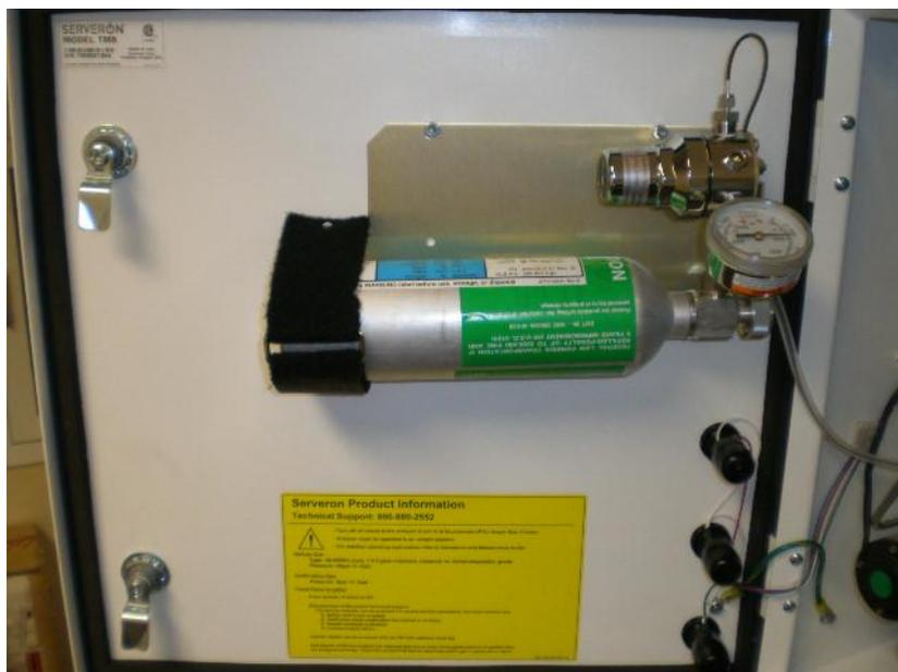
图 23 标气瓶的安装
