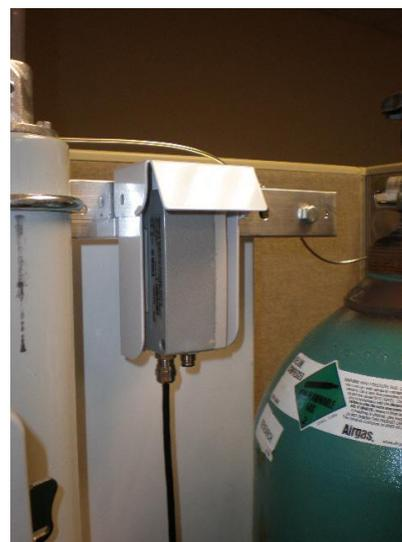
图 20 防雨罩的安装
