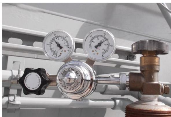
Figure 20 : Régulateur d'hélium
