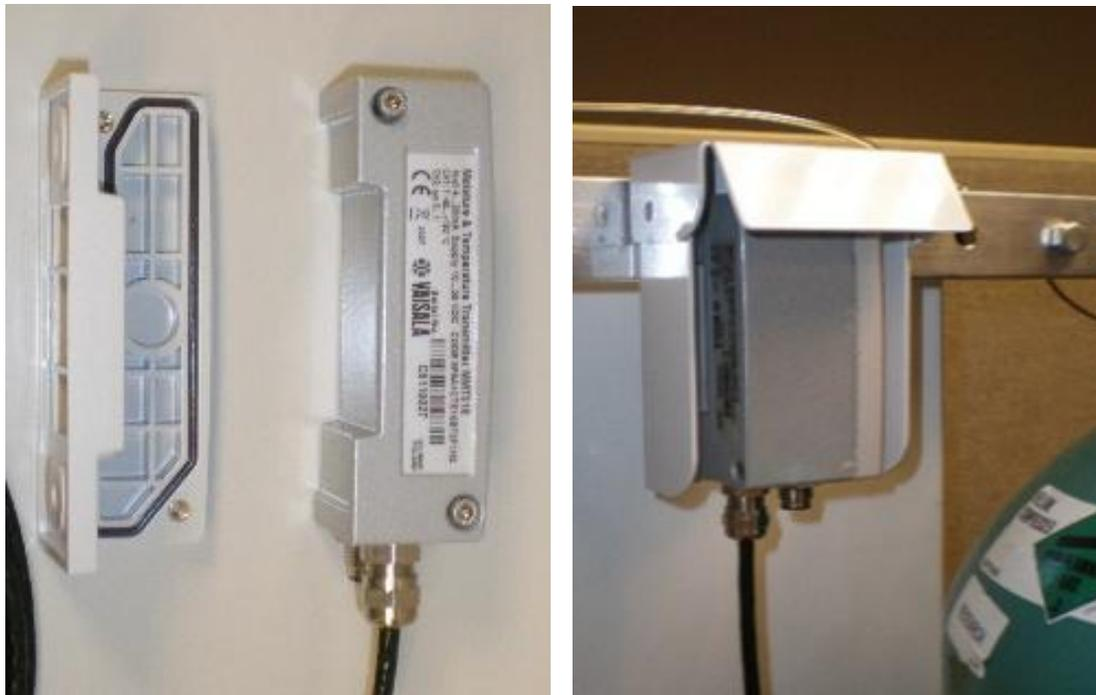
Figure 18 : Unité du transmetteur/base et protection anti-pluie installés
