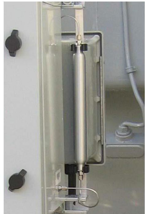
Figura 19: Secador de helio
